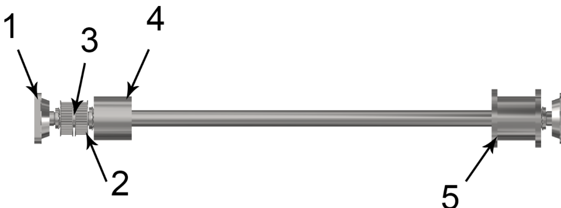
Obrázek 6 Konstrukce osazené hřídele
