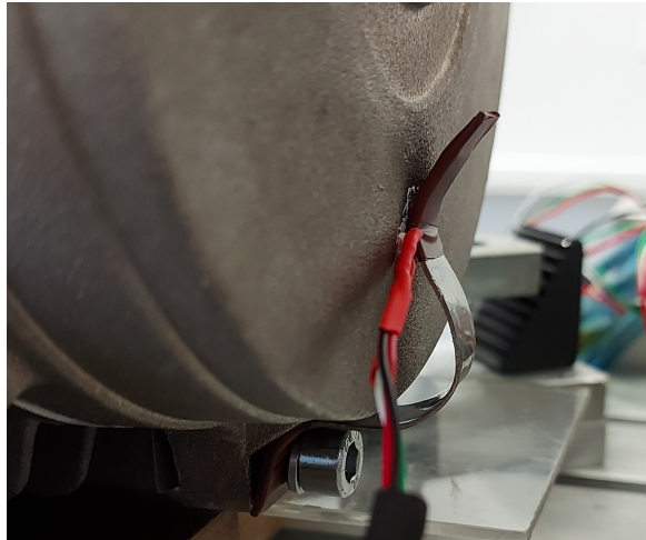
Obr. 4.10: Osazení ložiskového štítu LSPMSM teplotním čidlem.
