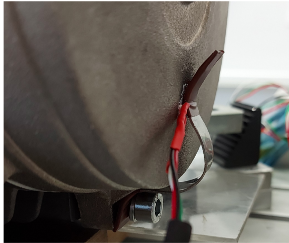
Obr. 4.10: Osazení ložiskového štítu LSPMSM teplotním čidlem.
