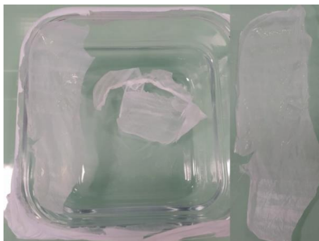
Obrázek 17: Membrána z alkalického kaseinu sušení při 50°C
