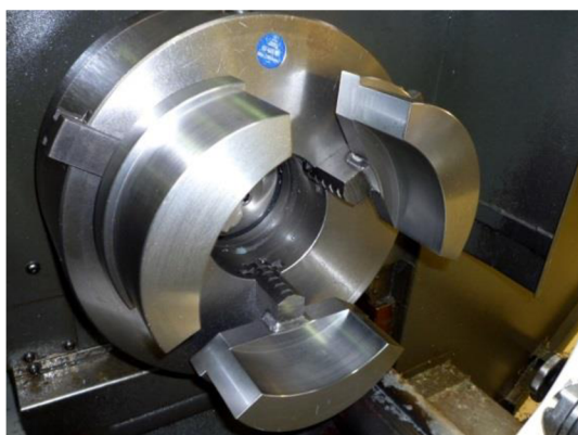
Obr. 3.8 Speciální čelisti vlastní výroby.
