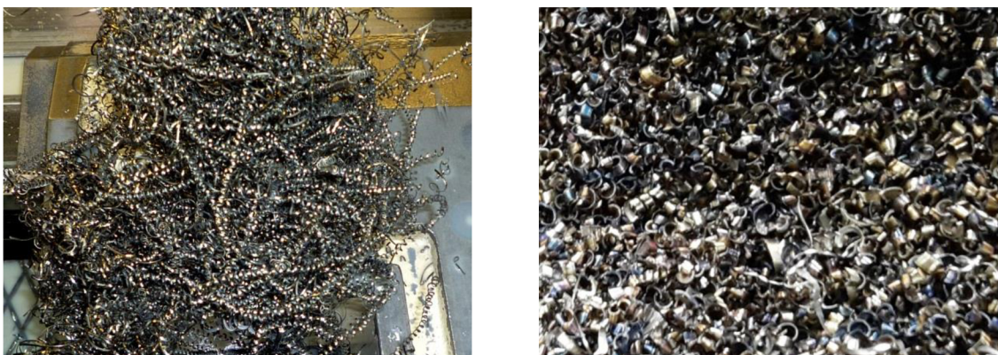
Obr. 4.10 Rozdíl ve tvaru třísek před zefektivněním (vlevo) a poté (vpravo).
