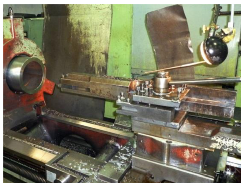
Obr. 3.6 Nástroj v antivibrační tyči připravené k obrábění.
