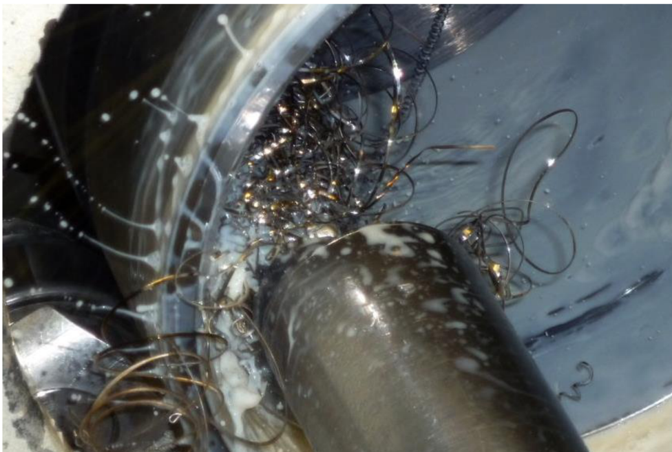
Obr. 4.9 Hromadění třísek v místě řezu a okolo nástroje.
