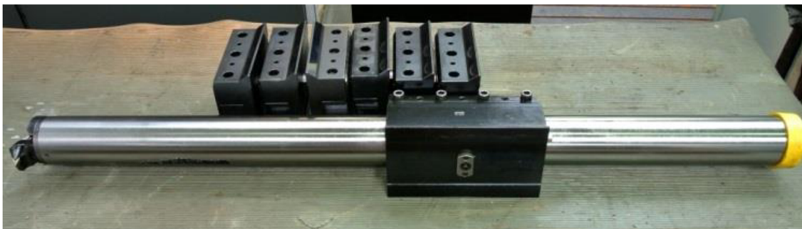
Obr. 4.8 Nová antivibrační tyč od firmy Sandvik Coromant.
