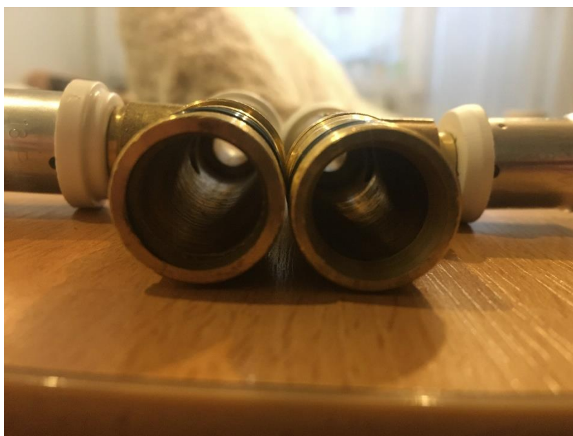
Obrázek 102 - Porovnání 2 typů fitinek - světlosti potrubí
