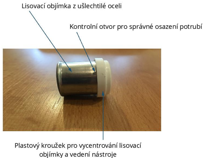
Obrázek 86 - Lisovací objímka s plastovým kroužkem
