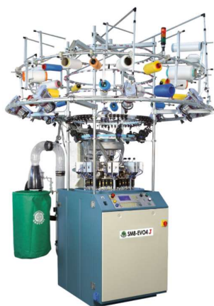
Obr. 2 Pletací stroj SANTI SM8-EVO4J Single Jersey, [7]
