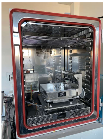
Obr. 32 Přístroj Sweating Guarded Hotplate (SGHP), zdroj: [vlastní]
