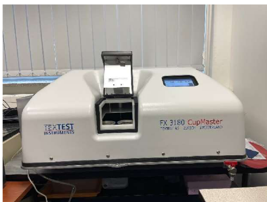
Obr. 33 Přístroj na měření propustnosti vodních par TEXTEST FX 3180 Cup Master, zdroj: [vlastní]
