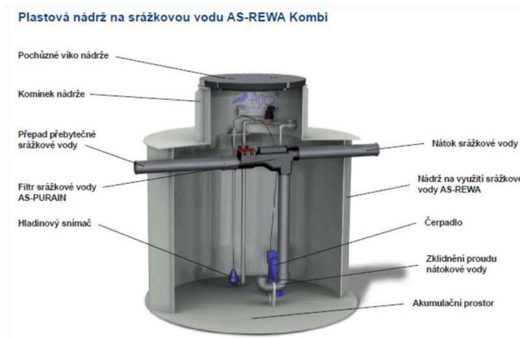
Obr. č. 16: Nádrž na akumulaci dešťových a recyklovaných vod AS-REWA Kombi [29]
