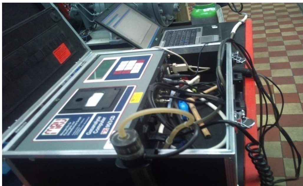
Obr.4.11. Měření s elektrochemickým analyzátozem typu MRU 95/3 CD.
