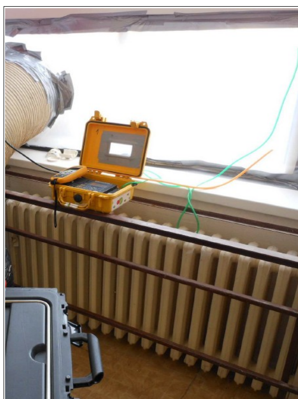
Obr. 28: Kontrola tlakové difference (zdroj: Foster Bohemia , ©2012)
