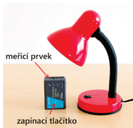
Obrázek 4.13: Sestava pro měření blikání žárovky. [12]
