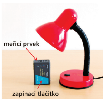
Obrázek 4.13: Sestava pro měření blikání žárovky. [12]
