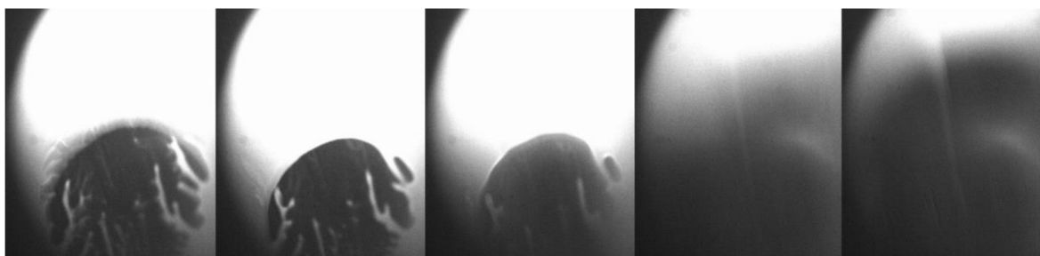
obr. 5.11 Přesun kontaktní oblasti během jednoho cyklu pod laterálním kondylem do sledovací pozice d
