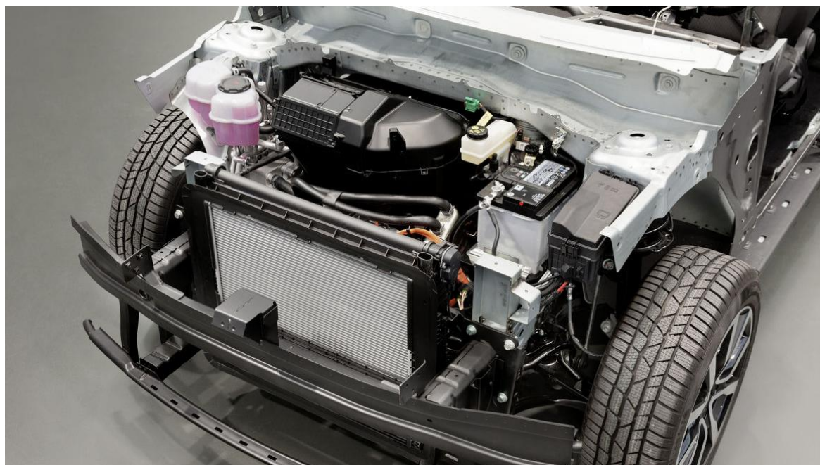
Obr. 2.15 Využití prostoru pod přední kapotou VW I.D. 3 (na platformě MEB) [38]
