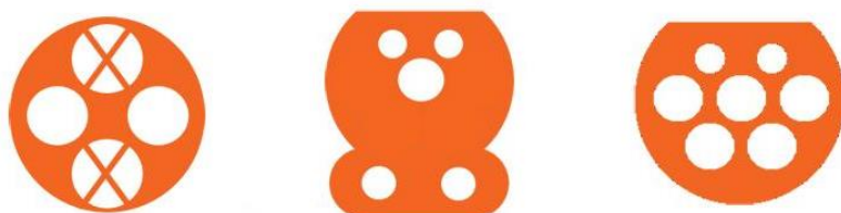
Obr. 2.30 Konektory pro vysokorychlostní nabíječky. Zleva CHAdeMO, CCS a Type 2 [70] (upraveno)
