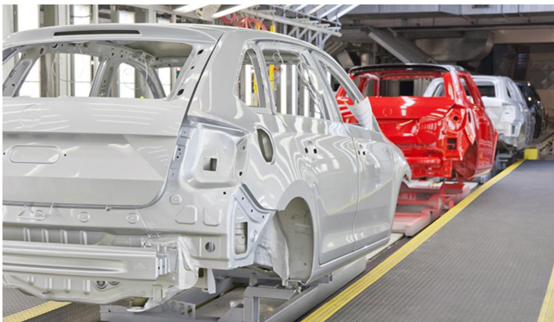
Obr. 6.13 Karoserie po montáži a lakování [119]
