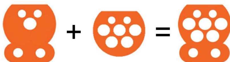
Obr. 6.3 Sjednocení dobíjecích konektorů CCS a Type 2 do jednoho [70] (upraveno)
