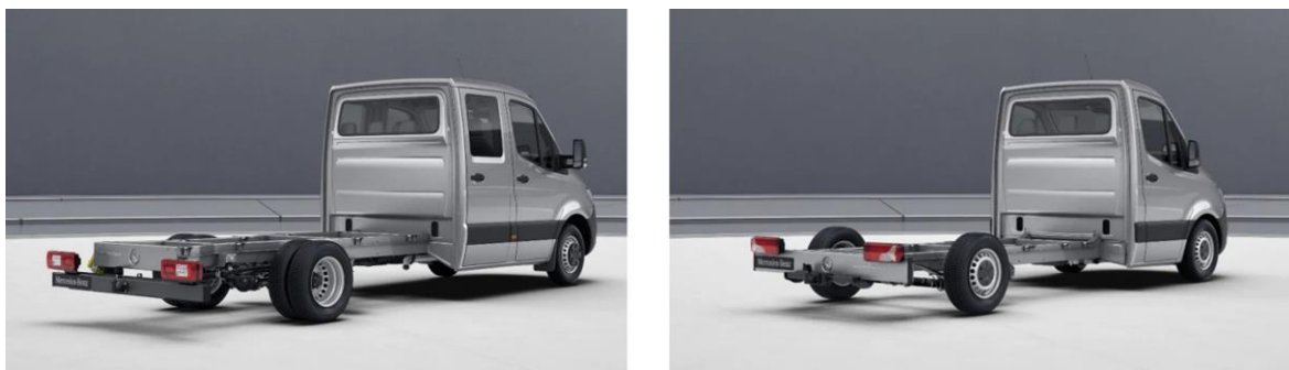
Obr. 2.31 Ukázka variability klasického rámu. Vlevo dvojitá kabina a dvoumontáž hnané zadní nápravy, vpravo vlečená zadní náprava s jednoduchou kabinou (Mercedes Sprinter) [72] (upraveno)
