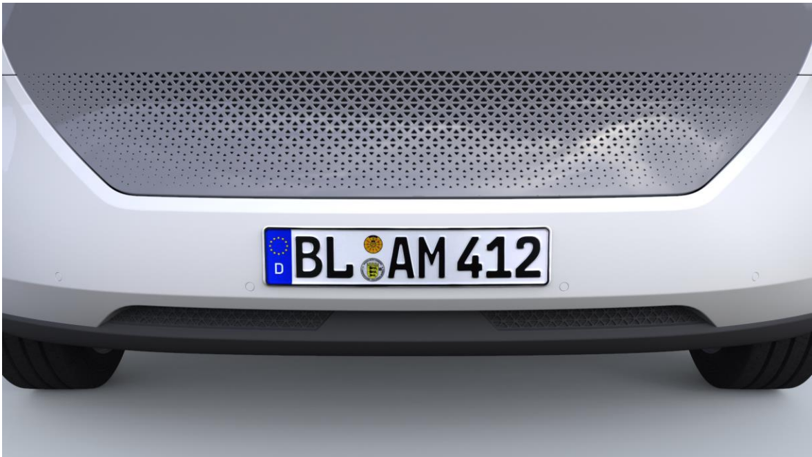
Obr. 5.17 Perforovaná kapota a dolní mřížka sání
