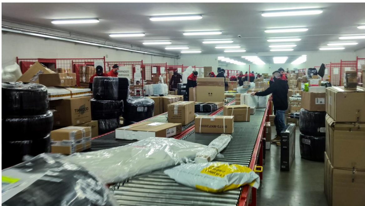
Obr. 3.8 Proces ranní vykládky – válečkový pás se zásilkami, klece
