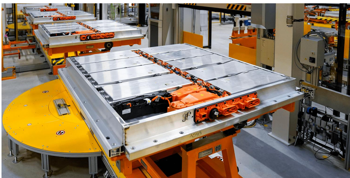
Obr. 2.27 Battery pack modulární platformy VW MEB [57]
