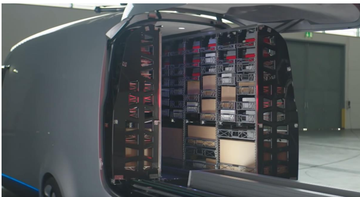
Obr. 4.1 Výměnná kazeta s automatickým výdejem konceptu Mercedes Vision Van [107]
