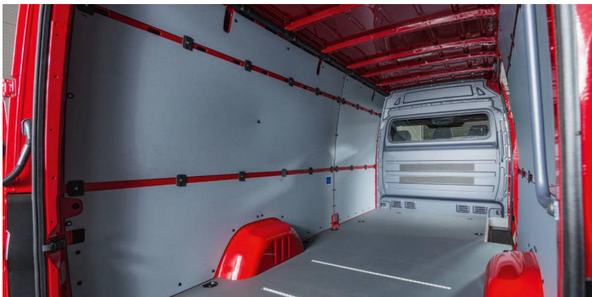
Obr. 3.2 Nákladový prostor s krycím obložením stěn [88]
