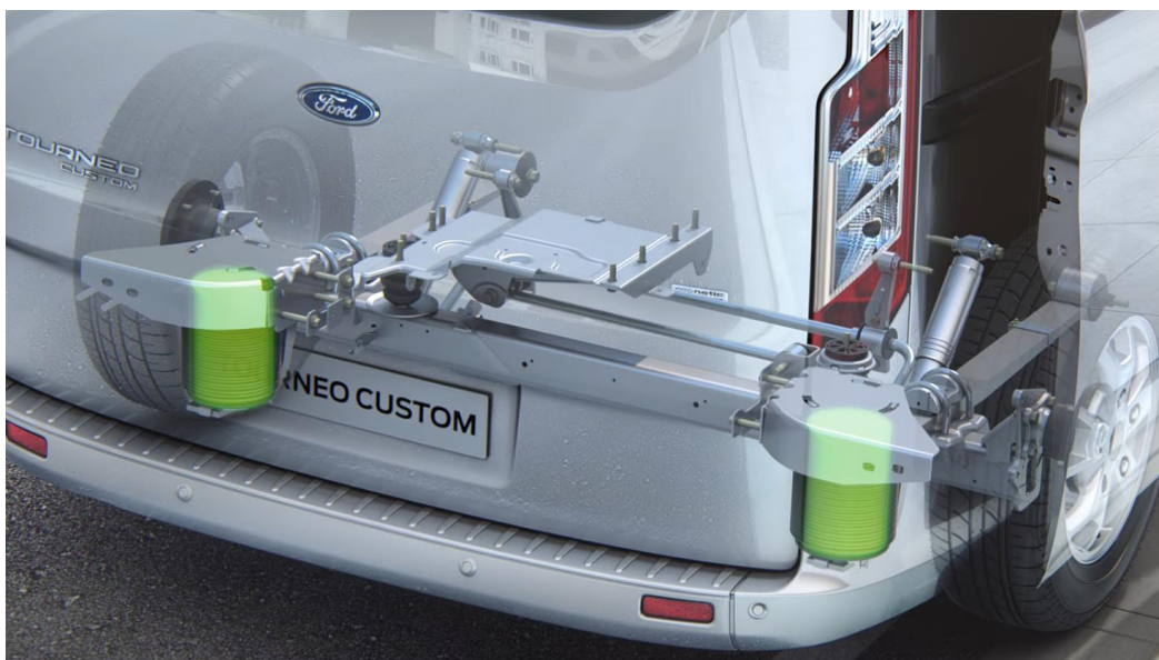
Obr. 2.32 Odpružení vzduchovými vaky vozu Ford Transit/Tourneo Custom [73]
