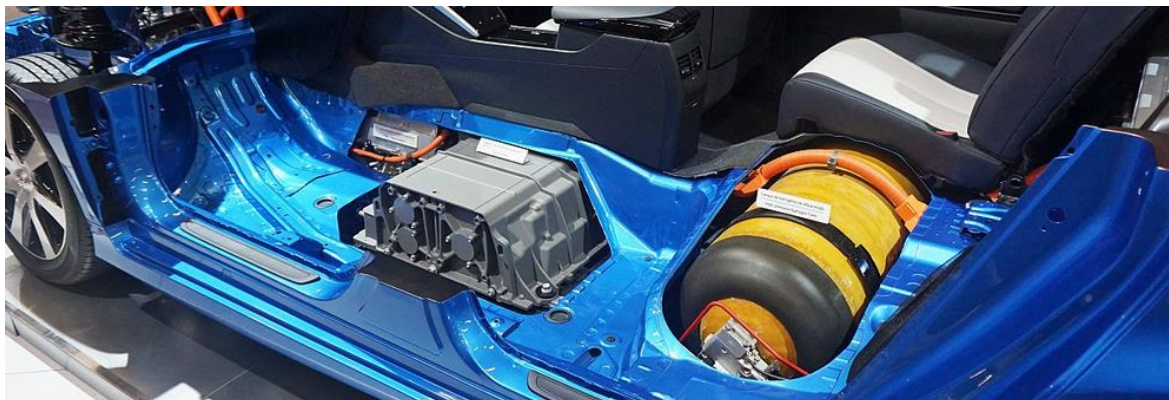
Obr. 2.28 Palivový článek a vysokotlaká nádrž Toyoty Mirai [60]
