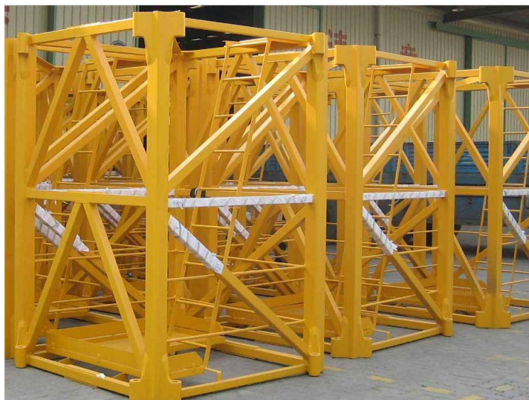
Obr. 3: jednotlivé segmenty určené pro stavbu věžového jeřábu-převzato z [3]
