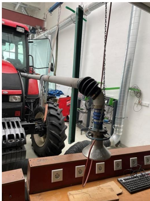
Obr. 22 – Upravené sání vzduchu do motoru
