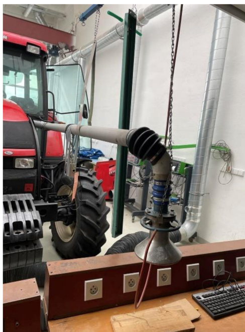
Obr. 22 – Upravené sání vzduchu do motoru
