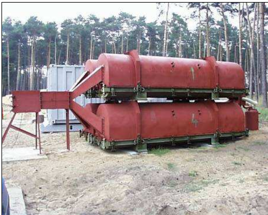
Příloha č. 1 – Sběrné nádrže na nevybuchlou munici v areálu VTÚVM Slavičín ( originál, 2010 ).
