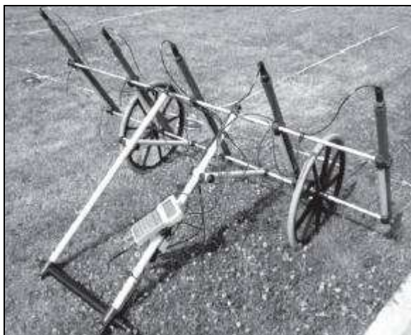
Obr. č. 12 – Infračervený snímač připevněný na nemagnetickém a nevodivém podvozku (Pokorný, Pokorný, 2009).
