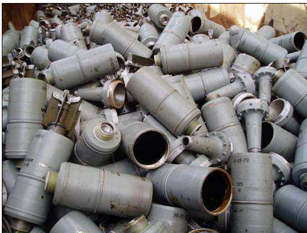
Příloha č. 10 – Recyklovatelné kovové materiály z delaborované munice ( originál, 2011 ).
