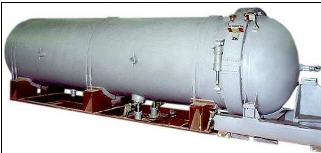
Obr. č. 14 – Velká výbuchová komora určená k ničení až 16 kg TNT (ADC, on-line ).
