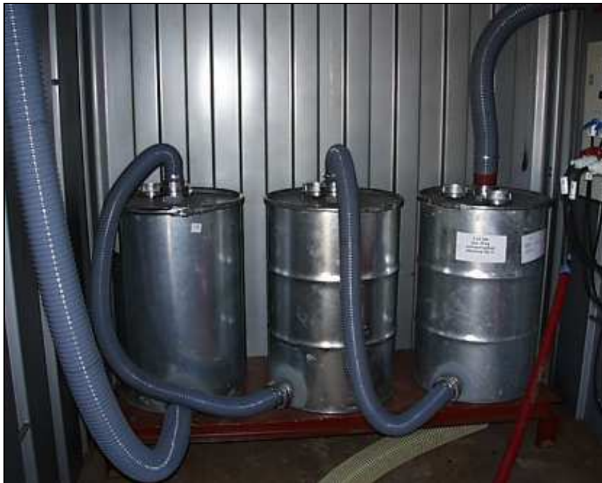
Příloha č. 3 – Absorbéry s aktivním uhlím pro záchyt par a organických látek ( originál, 2010 ).
