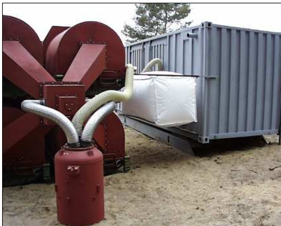
Příloha č. 2 – Sběrné nádrže s výbuchovou komorou, vzdušníkem a prostorem pro čištění zplodin ( originál, 2010 ).
