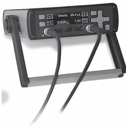
Obrázek 34: Testovací ultrazvukový přístroj Pundit Lab určený pro laboratorní provoz [56].
