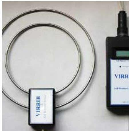
Obrázek 18: Zářič a přijímač založené na metodě fázového posunu [46].
