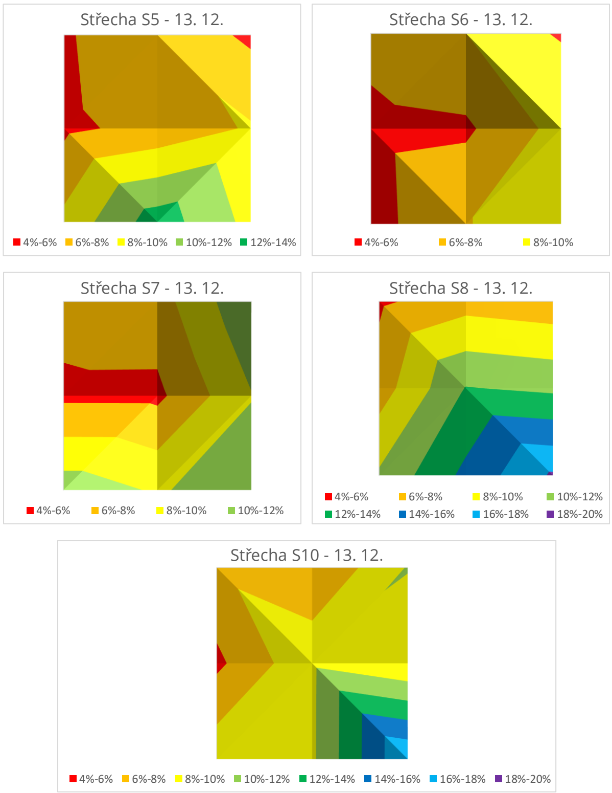
Obrázek 55: Plošné rozdělení povrchové vlhkosti na střechách stanovené odporovou metodou 13. 12. 2022.
