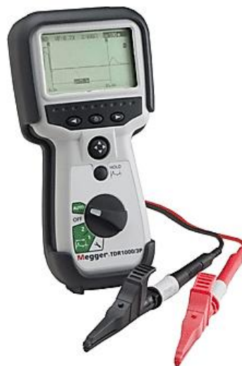
Obrázek 16: Snímač založený na principu pulsní reflektometrie [44].
