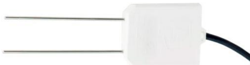
Obrázek 33: CS655 – snímač objemové půdní vlhkosti [55].
