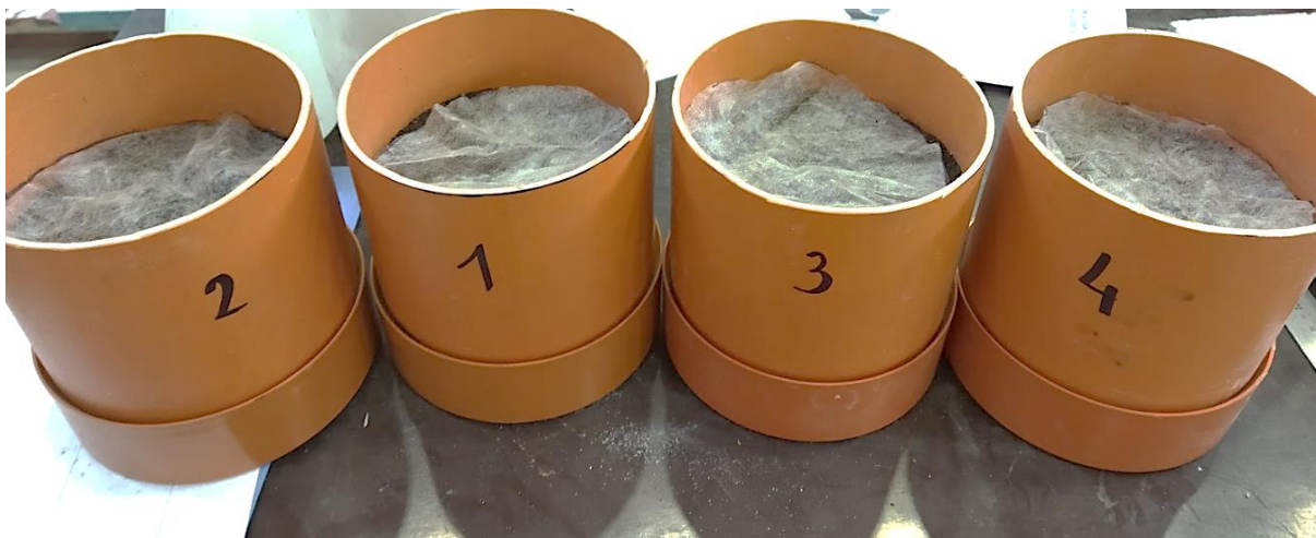
Obrázek 21: Vzorky umístěné v kontejnerech opatřeny síťovinou a tkaninou.
