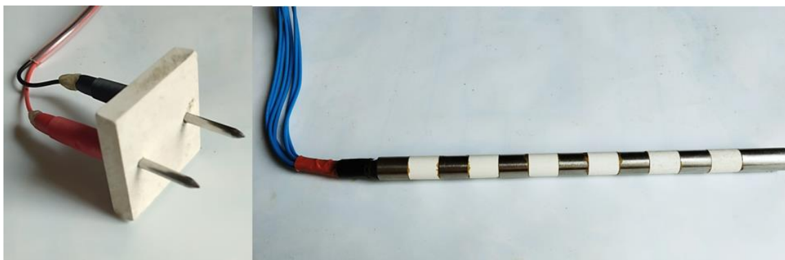
Obrázek 29: Měřicí sondy Z-metru, povrchová sonda vlevo a hloubková sonda vpravo [49].
