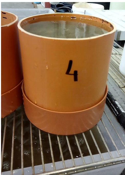
Obrázek 23: Vzorek zaletý vodou, jejíž hladina dosahuje po horní rysku.
