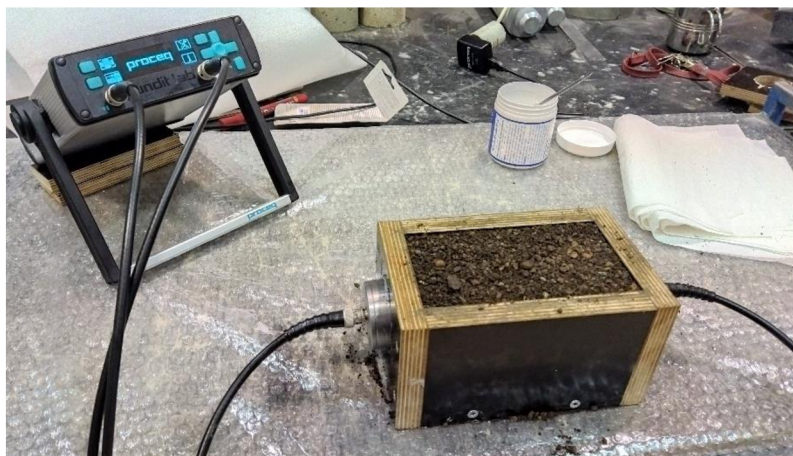
Obrázek 40: Měření průchodu ultrazvukových vln vzorkem substrátu.
