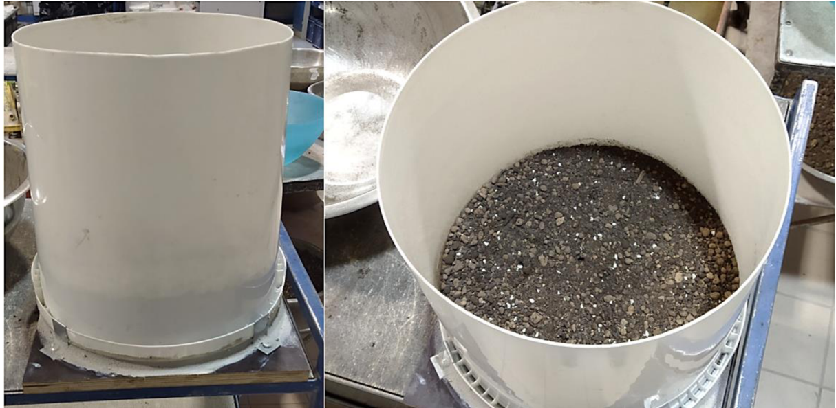
Obrázek 36: Nádoba vytvořená pro kalibraci kapacitních a odporových přístrojů.
