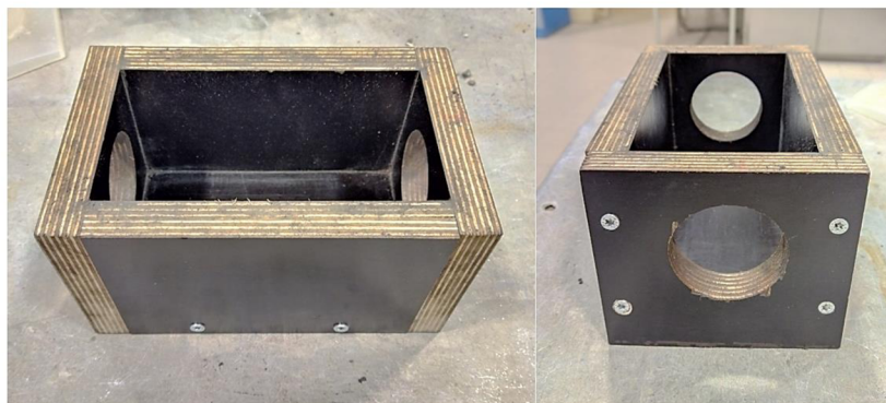
Obrázek 39: Nádoba užitá pro kalibraci ultrazvukového přístroje.
