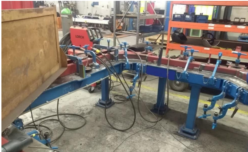
Obr. 33: Nesystematické umístění vysokotlaké hadice se stlačeným vzduchem
