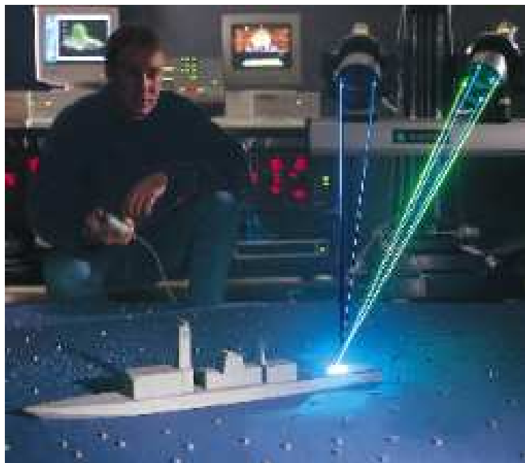
Obr. 3.6 Proměrování trupu lodi metodou 3D LDA [23]
