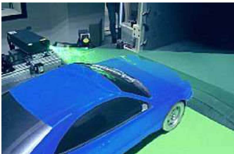
Obr. 3.0 Ukázka využití metody PIV, v automobilovém průmyslu – aerodynamický tunel [19]
