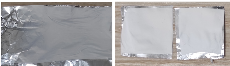
Obr. 7.3: Nanovláknena spinována na alobal (vlevo) a nanovláknena nastříhána na vzorky 2x2 cm (vpravo)
