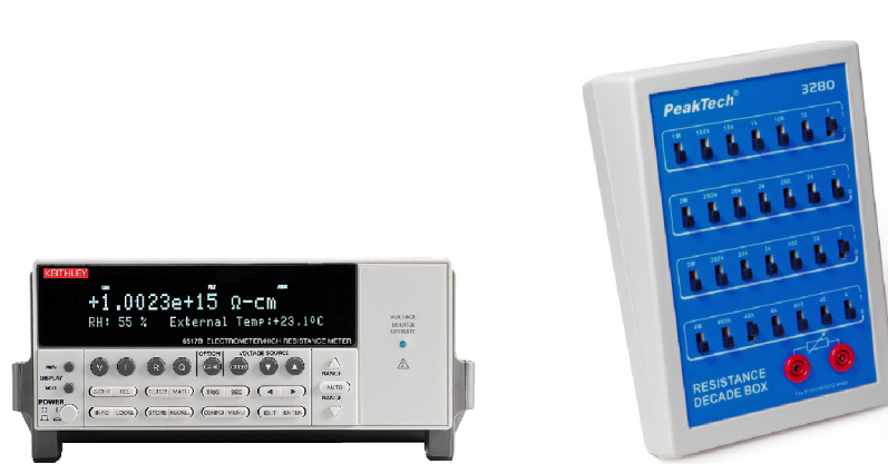
Obr. 7.13: KEITHLEY elektrometr (vlevo) [37] a odporový dekádový box (vpravo) [38]
