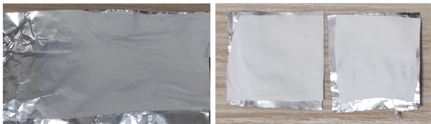
Obr. 7.3: Nanovláčna spinována na alobal (vlevo) a nanovláčna nastříhána na vzorky 2x2 cm (vpravo)
