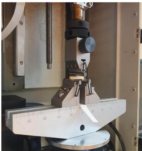
Obr. 17 Umístění vzorku mezi 3 válečky
