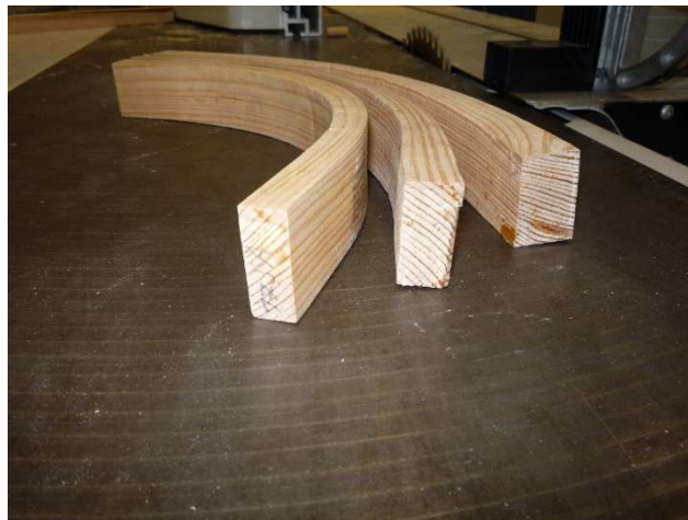
Obr. 27 Čela vzorků jsou bez porušení, nedošlo ke smyku po letokruzích
