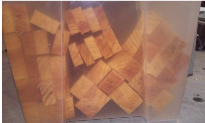
Obr. 8 Vzorky jsou řádně popsané a svázané do skupin o stejné tloušťce
