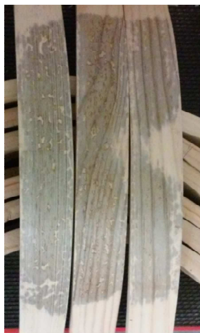
Obr. 22 Barevná změna po korozi
