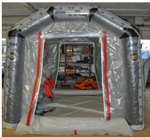
Obrázek č.18: Dekontaminační stan pro dekontaminaci zasahujících.
