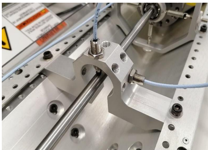
Obrázok 3.3 Spôsob uchytenia pre sondy výchylky
