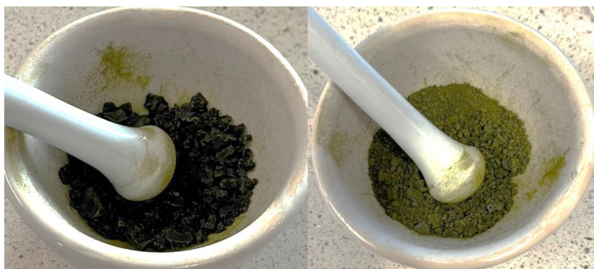
Obr. 36: Príprava suchej biomasy; Obrázok vľavo sú veľké kusy suchej biomasy vysušené v peci; obrázok vpravo je rozdrvená suchá biomasa na prach v mažiari.
