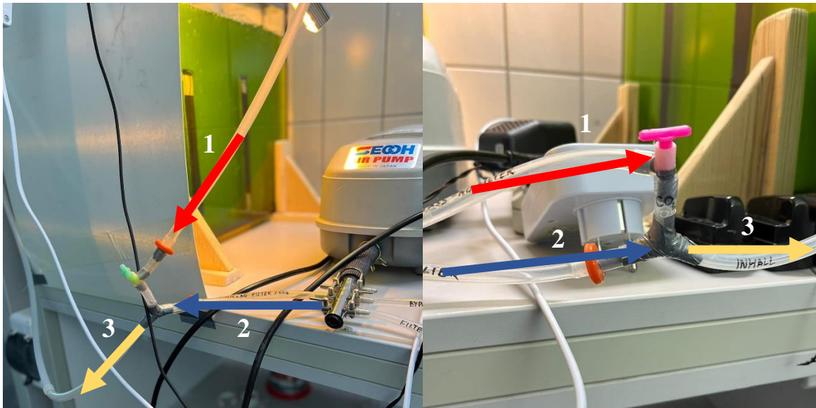
Obr. 30: Systém dodávania CO 2 ; 1. 100% CO 2 ; 2. Vzduch z pumpy; 3. Obohatený vzduch o CO 2 na 4% až 8%.
