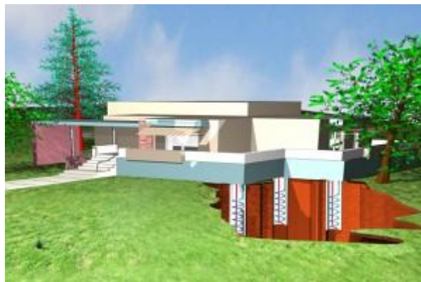
Obr. 35 Vizualizace energetických pilot pod objektem [20]
