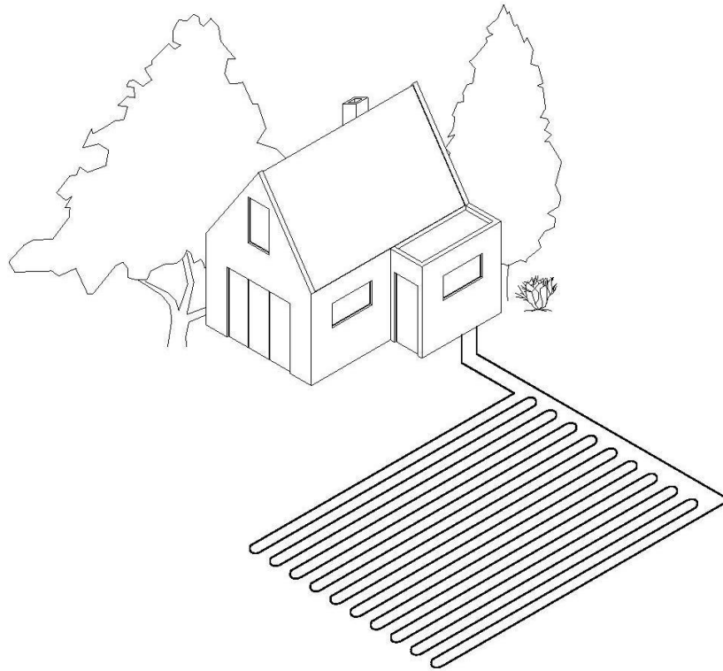
Obr. 18 Tepelné čerpadlo země – voda s plošným výměníkem
