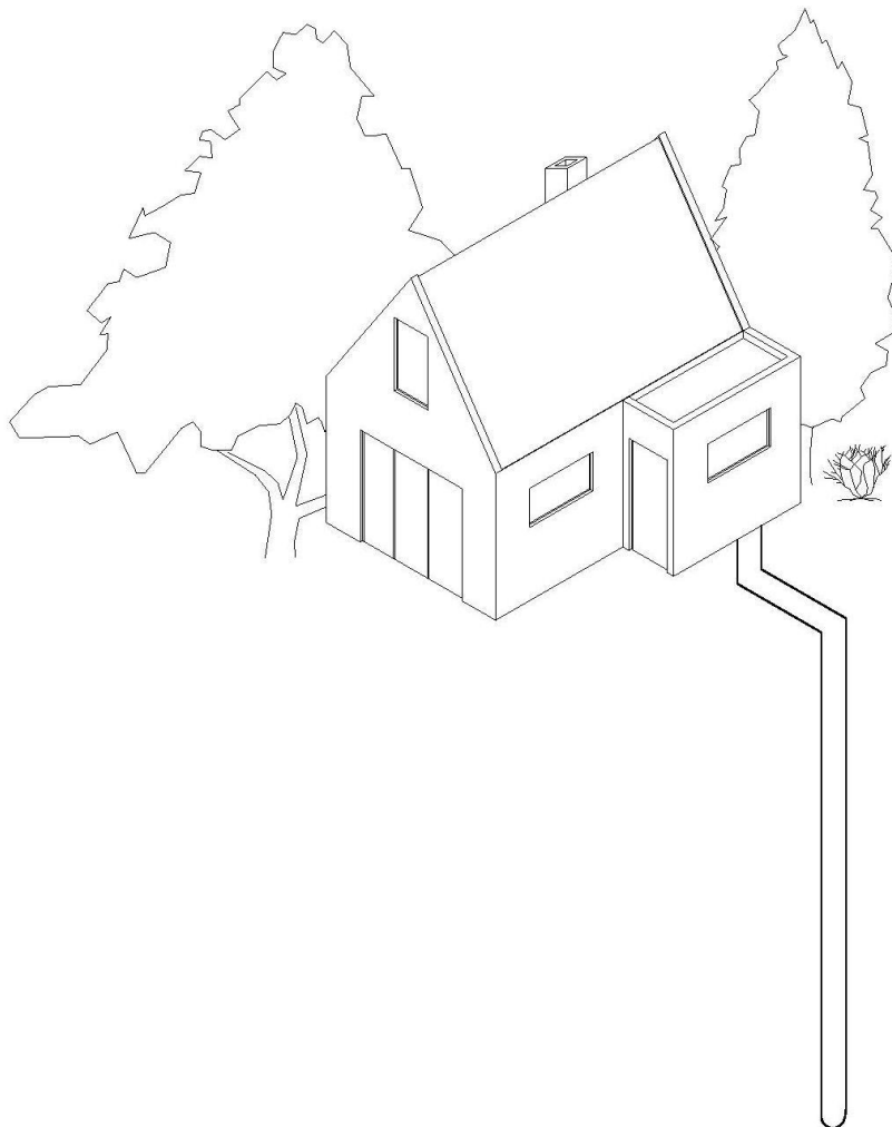
Obr. 25 Tepelné čerpadlo země – voda s vertikálním výměníkem
