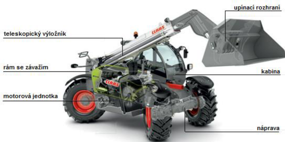
Obr. 1 Stavba teleskopického manipulátoru [1]
