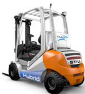
Obr. 10 Hybridní vysokozdvizný vozík Still RX 70 Hybrid s elektrickým přenosem výkonu [14]
