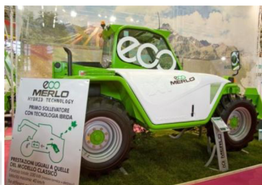
Obr. 11 Hybridní teleskopický manipulátor Merlo P41.7 Hybrid s elektrickým přenosem výkonu [17]
