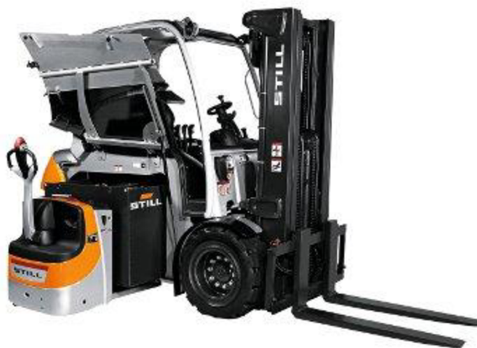
Obr. 16 Výměnný systém modulu baterií u vysokozdvížeňového vozíku Still RX 60 [14]
