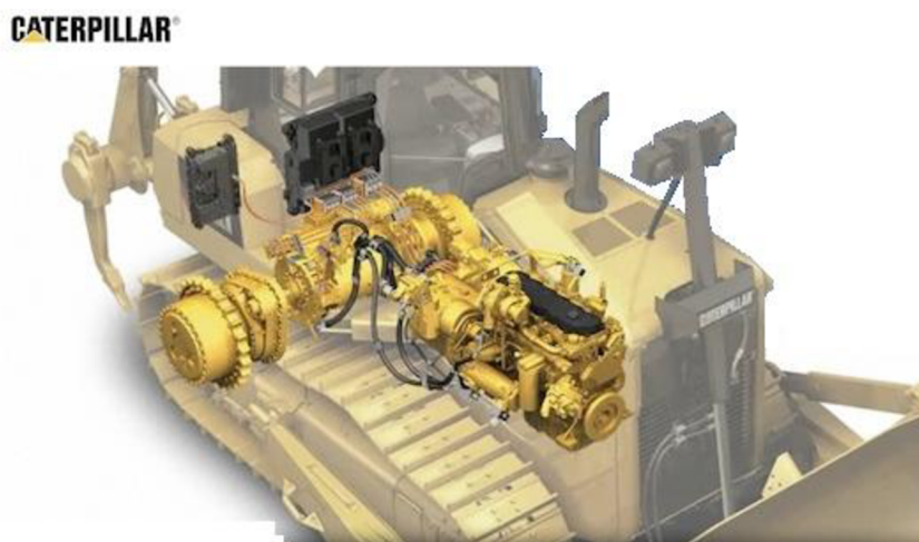
Obr. 2 Schéma diesel-elektrického přenosu výkonu dozeru Caterpillar D7E [4]
