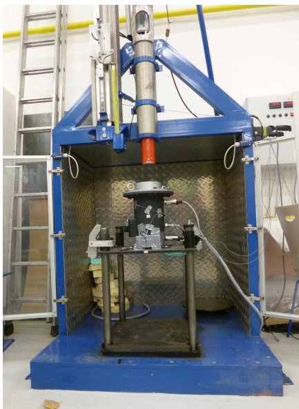
Obr. 8: Zařízení „rázová komora“ využití pro testování jednotky eCall
