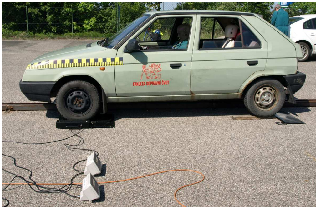
Obr. 8.3: Metoda vážení zkušební automobilu před testem, ustavení vozidla ve vodorovné poloze [vlastní zpracování]
