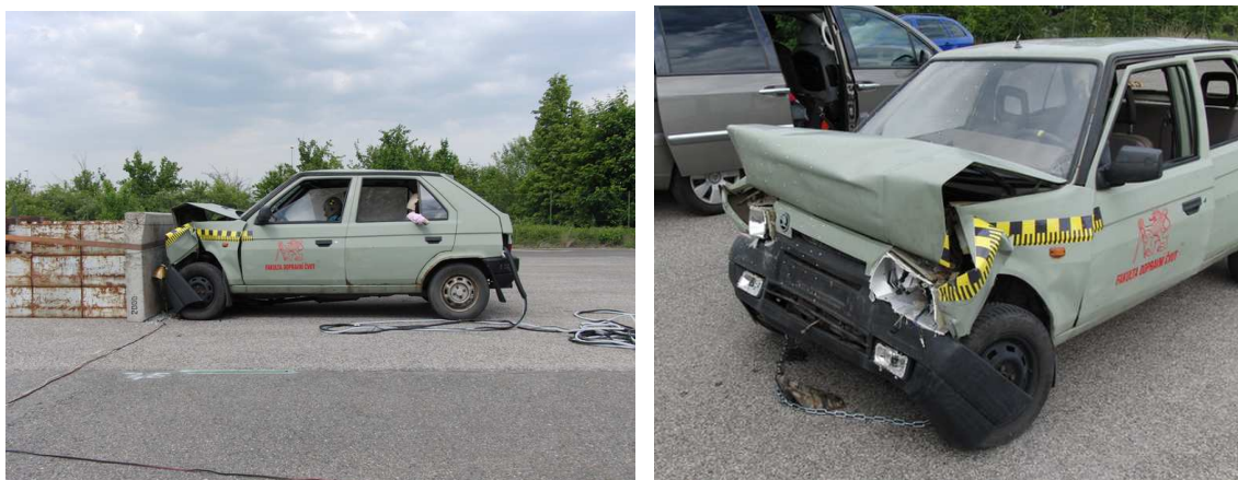
Obr. 8.7: Finální pozice po nárazu a výsledné deformace karoserie zkušebního vozidla [vlastní zpracování]
