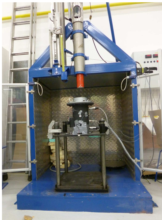
Obr. 9.12: Zařízení „rázová komora“ využitě pro testování jednotky eCall [vlastní zpracování]
