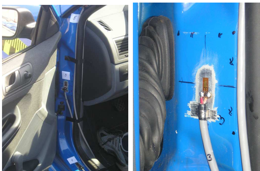
Obr. 9.5: Umístění tenzometrů na karoserii vozidla Škoda Fabia v oblasti levých předních dveří [26]
