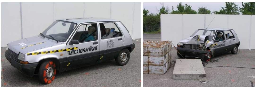
Obr. 8.18: Vozidlo Renault 5 GTD před (vlevo) a po kolizi (vpravo) [28]
