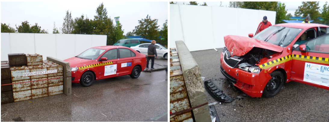
Obr. 8.14: Stav zkušebního vozidla Škoda Rapid 1,6 TDI před nárazem (vlevo) a po nárazu (vpravo) [vlastní zpracování]
