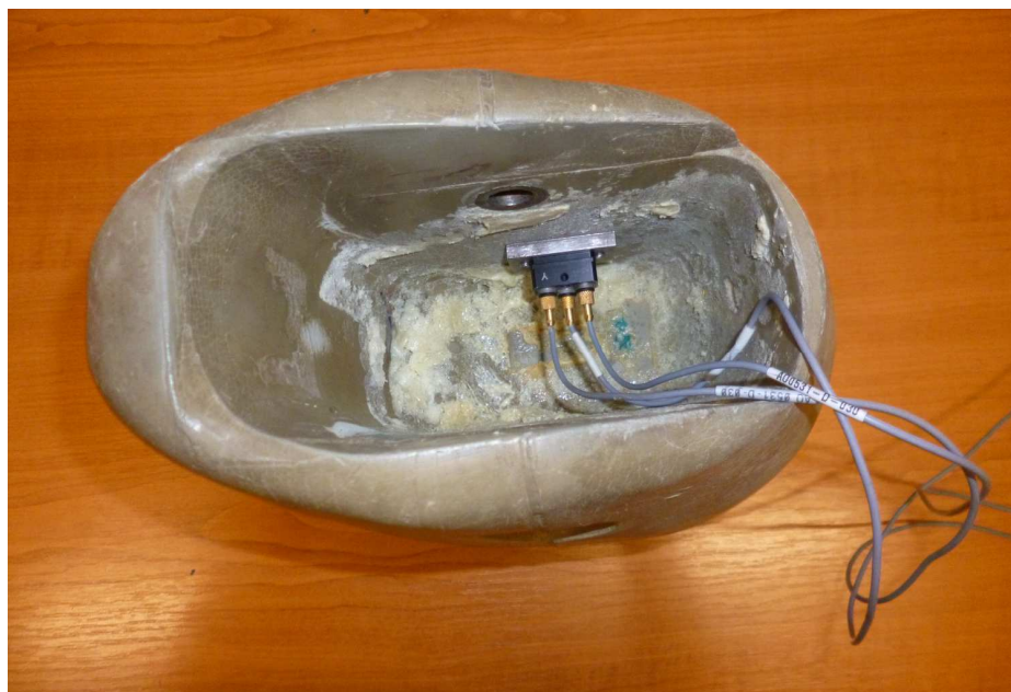
Obr. 8.5: Figurína ÚSMD Manikin – umístění tříosého akcelerometru v hlavě [vlastní zpracování]
