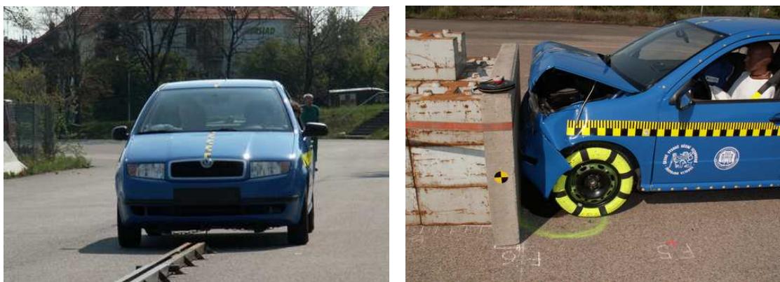
Obr. 8.10: Stav zkušebního vozidla Škoda Fabia 1,4 MPI před nárazem (vlevo) a po nárazu (vpravo) [26]
