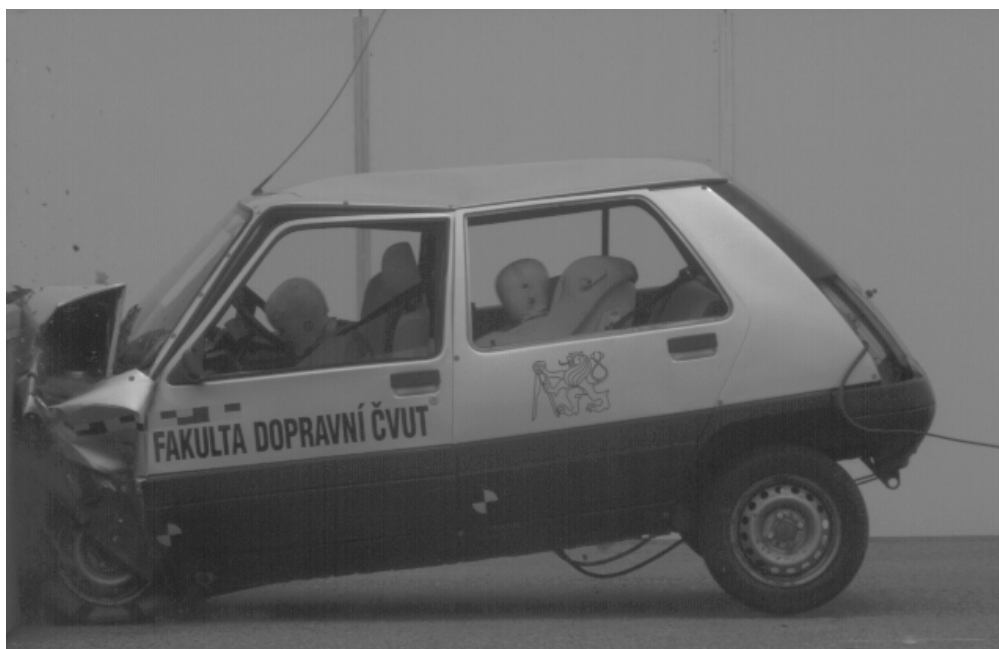
Obr. 8.19: Maximální deformace karoserie vozidla během nárazu (záznam z rychlokamery) [vlastní zpracování]
