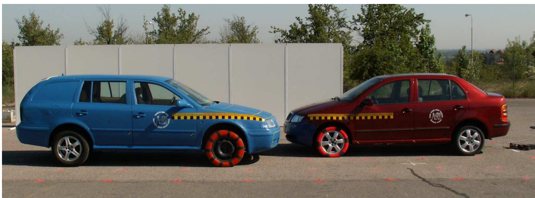
Obr. 8.23: Konfigurace zkušebních vozidel Škoda Fabia sedan a Škoda Octavia combi při testu čelním nárazem s přesahem 33 %. [27]
