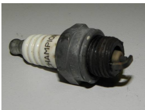
Svíčka v motoru spalující směs s E85 po 25. hodinách
