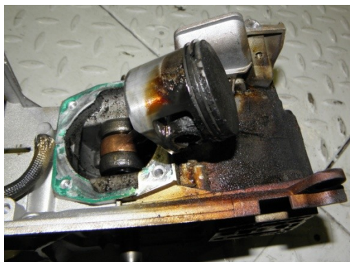
Motor E85 po sundání válce
