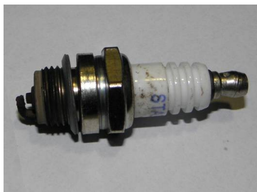
Svíčka v motoru spalující benzínovou směs po 50. hodinách
