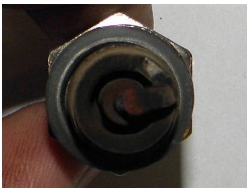
Svíčka v motoru spalující benzínovou směs po 50. hodinách
