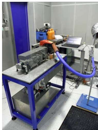
Propojení měřící aparatury s motorem
