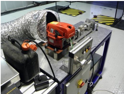
Zkušební stav připravený k brzdění na válcové brzdě
