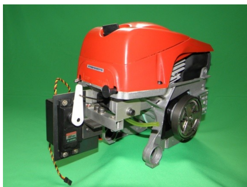
Motor připravený na montáž na stav
