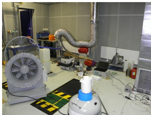
Měřicí soustava pro měření emisí
