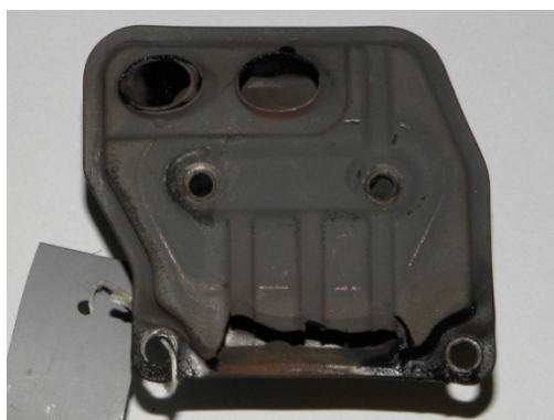
Poškození u tlumiče výfuku E85
