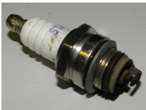
Svíčka v motoru spalující benzínovou směs po 25. hodinách
