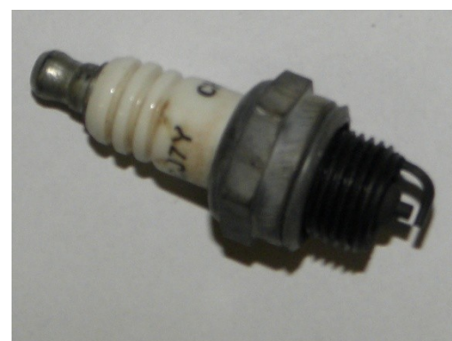
Svíčka v motoru spalující směs s E85 po 50. hodinách
