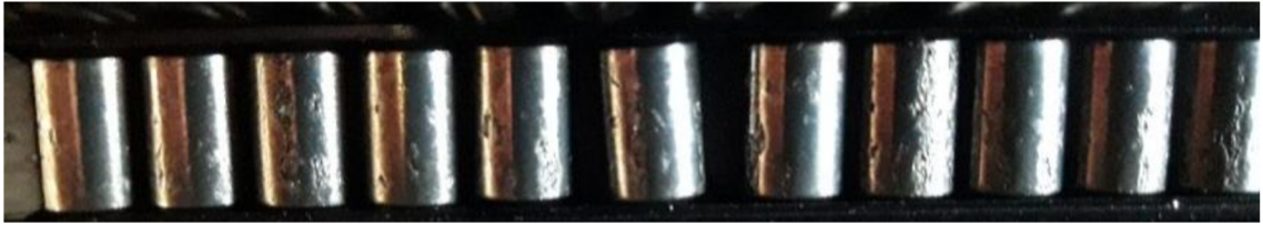
Obr. 4.4 Poškození valivých elementů – pitting
