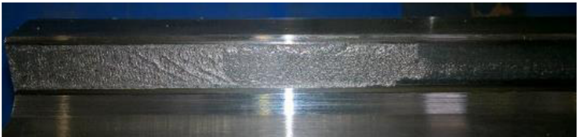
Obr. 4.6 Poškození vodícího profilu – pitting a abrazivní poškození
