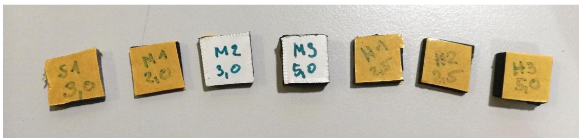
Obr. 6.18 Zkušební vzorky pryže s různou tvrdostí a tloušťkou pro pružné uložení snímače zrychlení vibrací. Tvrdost: S – měkká; M – středně tvrdá; H – tvrdá. Tloušťka: 2mm; 2,5mm; 3mm; 3,5mm a 5mm
