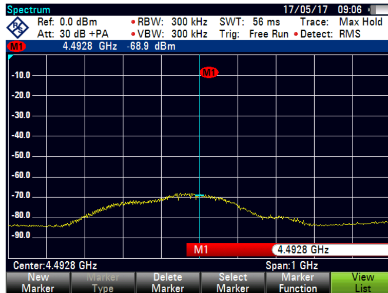
Obrázek 30 Spektrum vysílaného signálu Decawave modulu
