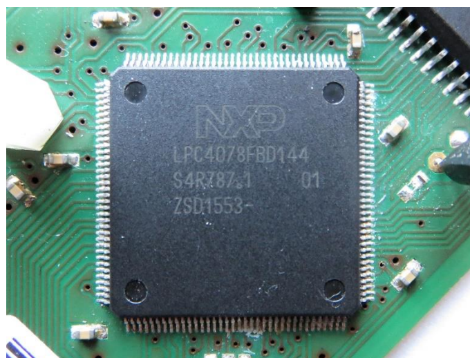
Obrázek 10 LPC4078 v pouzdře LQFP 144-pin
