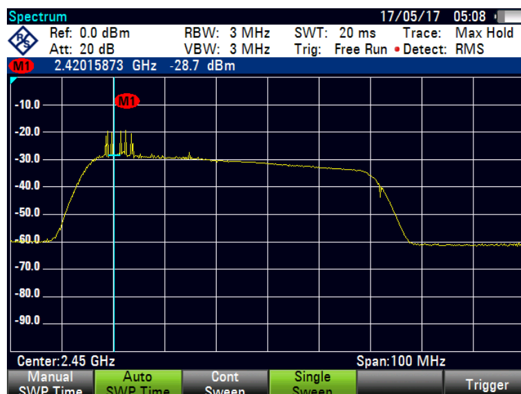
Obrázek 29 Spektrum vysílaného signálu Nanotron modulu
