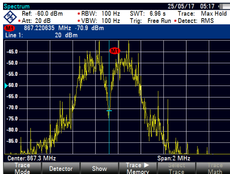
Obrázek 28 Detail spektra vysílaného signálu SX modulem
