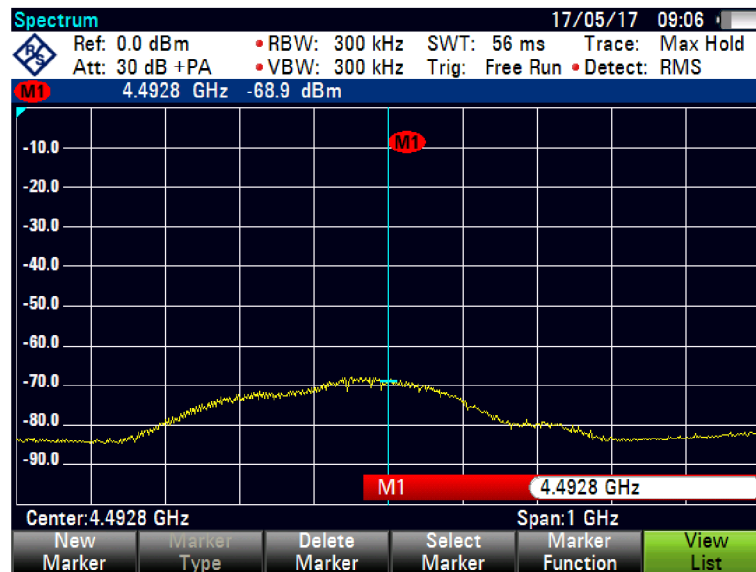
Obrázek 30 Spektrum vysílaného signálu Decawave modulu
