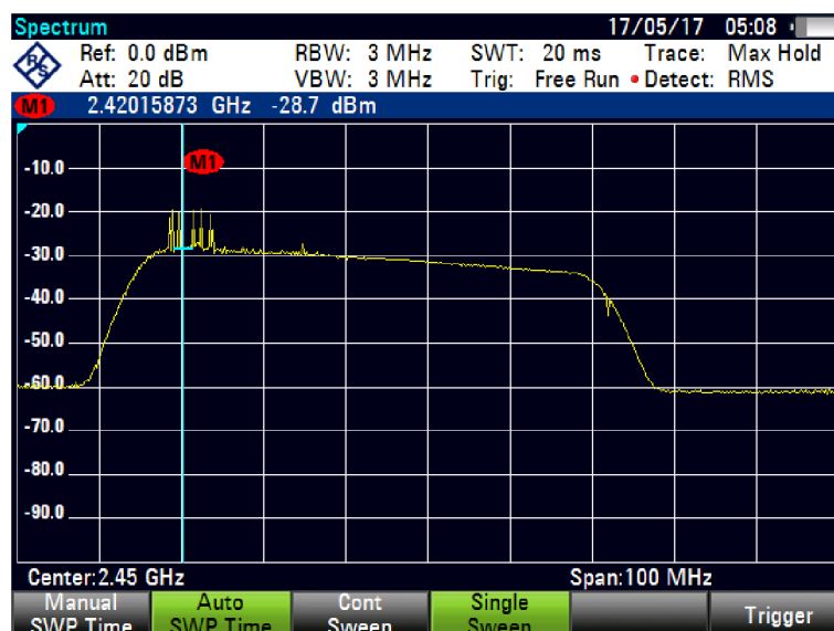
Obrázek 29 Spektrum vysílaného signálu Nanotron modulu
