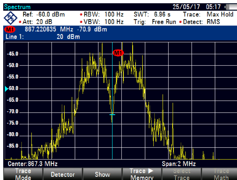
Obrázek 28 Detail spektra vysílaného signálu SX modulem
