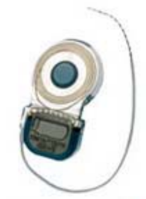
Obr. 2. Kochleární implantát MED-EL (SONATA)
