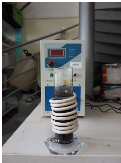
Obrázek 7 – Přístroj pro indukční ohřev s cívkou M a odměrným válcem se sedimentem s částicemi mikro Fe_3O_4 v koncentraci 50 g/l.
