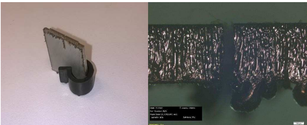
Obr. 27 – Upnutý a nevybroušený vzorek pro měření přibližné velikosti otřepů
