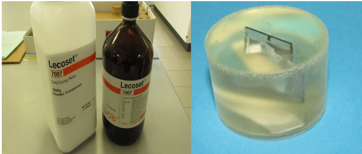
Obr. 28 – Pryskyřice Lecoset 7007 a vzorek zalitý v této pryskyřici
