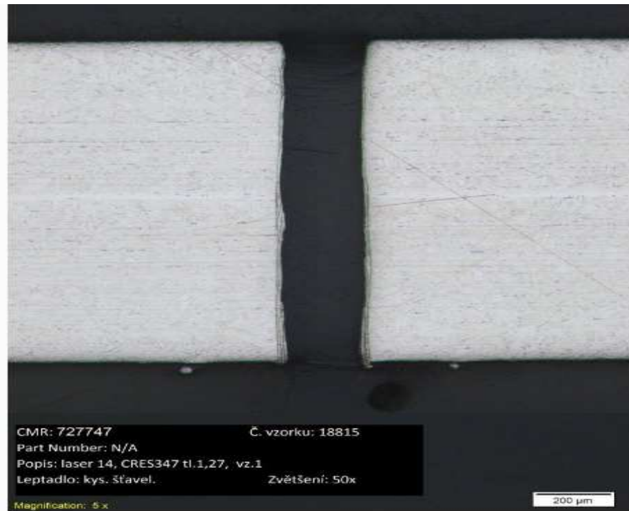
Obr. 30 – Vybroušený a vyleptaný vzorek připravený k měření
