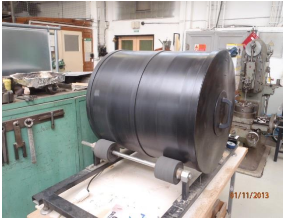
Obr. 10: Buben pro stanovení DU (foto: Přemysl Hlatký)
