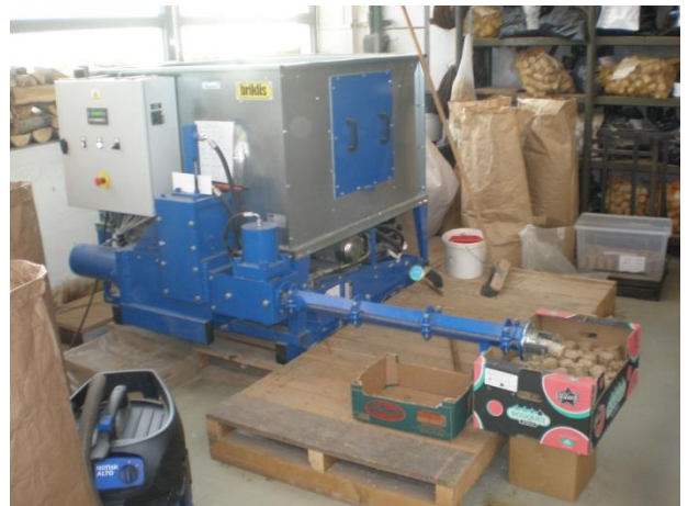
Obr. 7: Lis BrikStar 30 - 12 (foto: Přemysl Hlatký)
