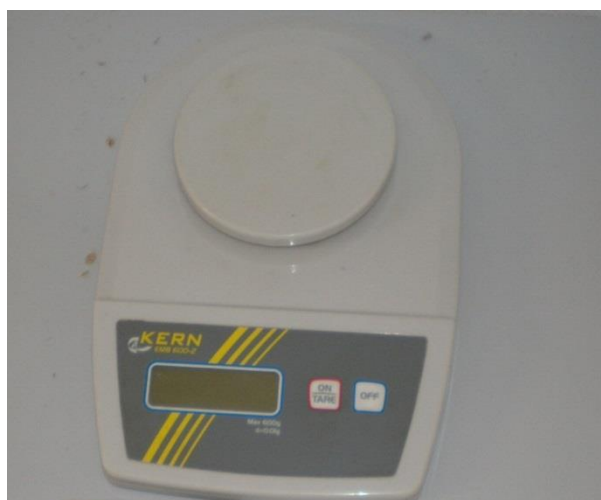
Obr. 5: Váha Kern EMB 600-2 (foto: Přemysl Hlatký)
