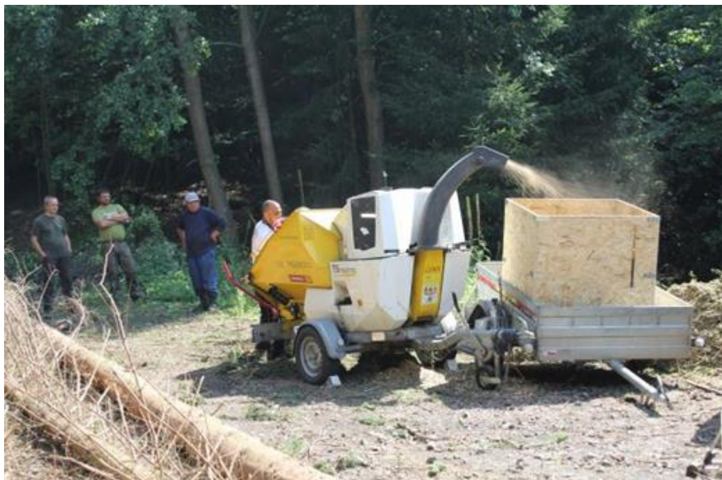
Obrázek č. 5 Výroba zelené štěpky do měřicí bedny (zdroj: vlastní fotodokumentace)
