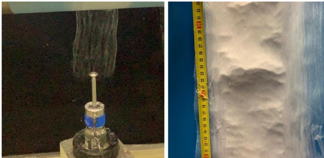
Obrázek 41: Nanovlákněná vlečka a nanovlákněná vrstva PVB 60 : PVB 75 8% (1:1, 30 kV)
