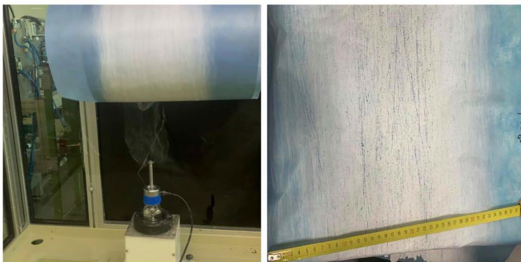
Obrázek 22: Nanovláknenná vlečka a nanovláknenná vrstva
