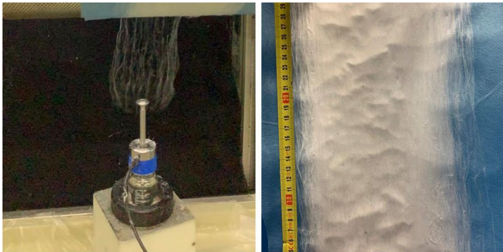
Obrázek 39: Nanovláknenná vlečka a nanovláknenná vrstva PVB 45 : PVB 60 12% (1:1, 37 kV)
