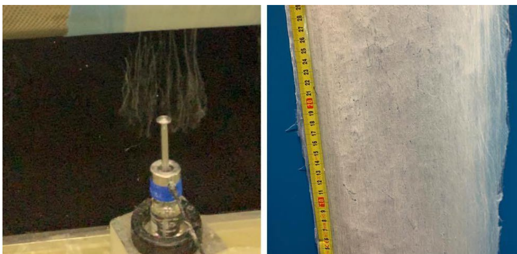
Obrázek 40: Nanovláknenná vlečka a nanovláknenná vrstva PVB 45 : PVB 60 14% (2:1, 30 kV)
