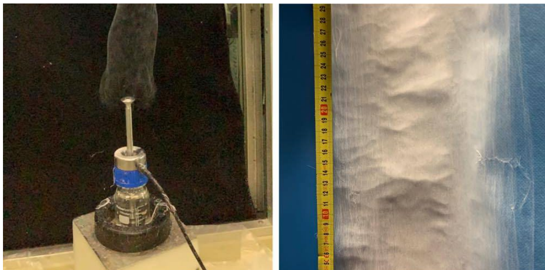
Obrázek 43: Nanovláknenná vlečka a nanovláknenná vrstva PVB 60 : PVB 75 6% (1:2, 30 kV)
