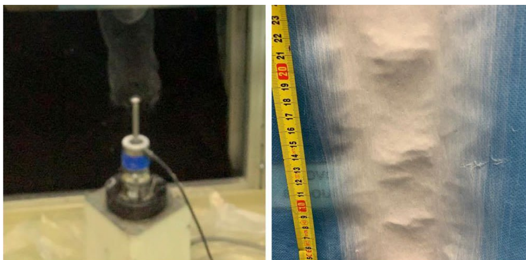
Obrázek 44: Nanovláknenná vlečka a nanovláknenná vrstva PVB 60 : PVB 75 6% (1:2, 25 kV)
