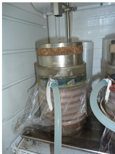
Obr. 3-16 První zkouška – lednice se vzorky a zkušební buňka bez izolace [15]
