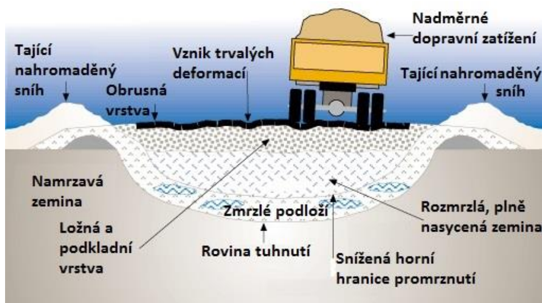
Obr. 2-3 Schéma zemního tělesa při ztrátě únosnosti [6]
