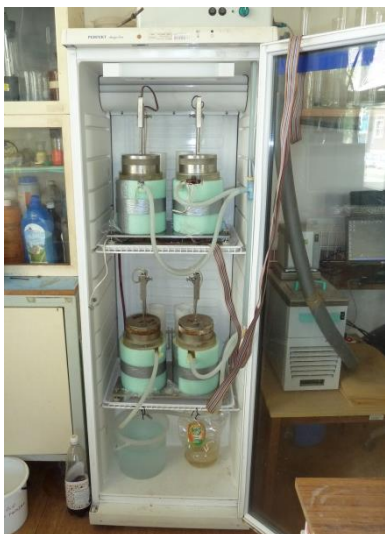
Obr. 3-19 Druhá zkouška – lednice se vzorky a zkušební buňka s izolací [15]
