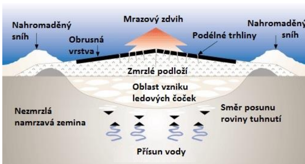
Obr. 2-2 Schéma zemního tělesa při vzniku mrazového zdvihu [6]
