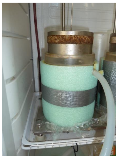
Obr. 3-19 Druhá zkouška – lednice se vzorky a zkušební buňka s izolací [15]
