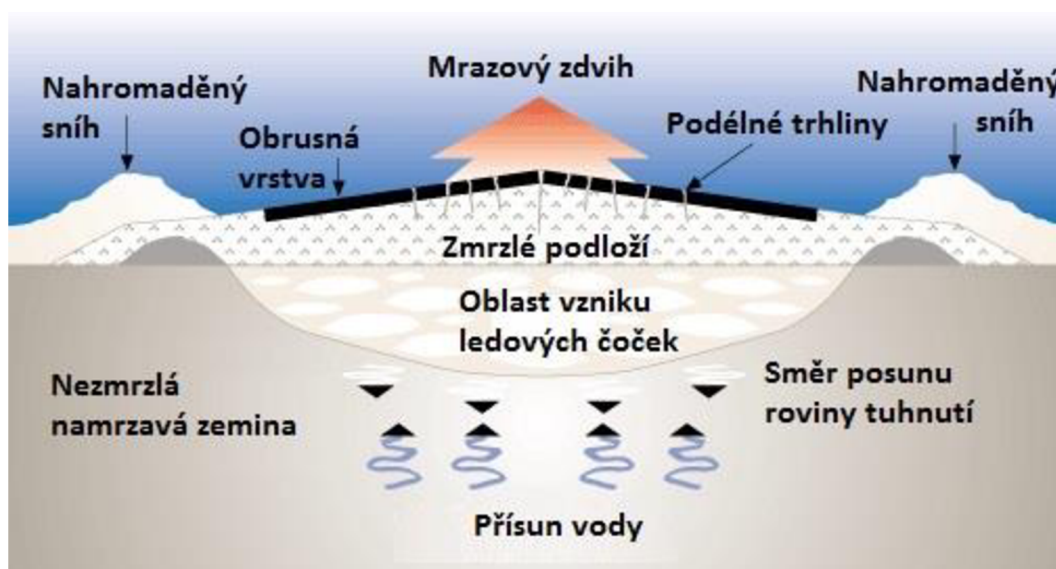
Obr. 2-2 Schéma zemního tělesa při vzniku mrazového zdvihu [6]
