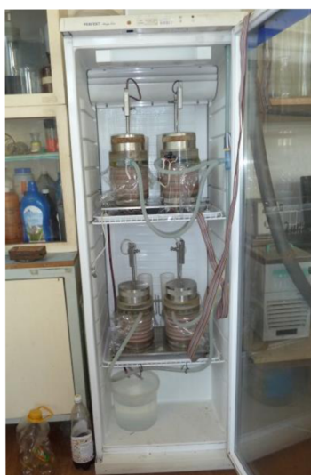
Obr. 3-16 První zkouška – lednice se vzorky a zkušební buňka bez izolace [15]
