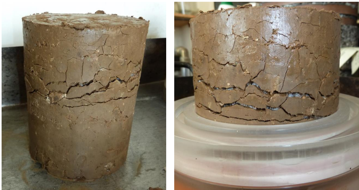
Obr. 3-17 Vzorek po průběhu zkoušky a detail oblasti vzniku ledové čočky [15]
