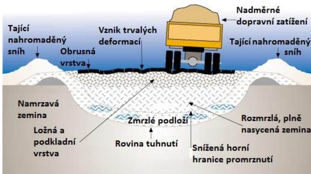
Obr. 2-3 Schéma zemního tělesa při ztrátě únosnosti [6]
