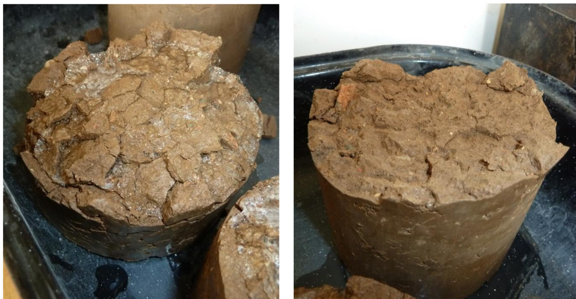
Obr. 3-17 Vzorek po průběhu zkoušky a detail oblasti vzniku ledové čočky [15]
