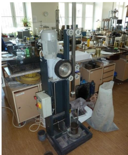
Obr. 3-15 Příklad přístroje pro metodu Proctor standard [15]
