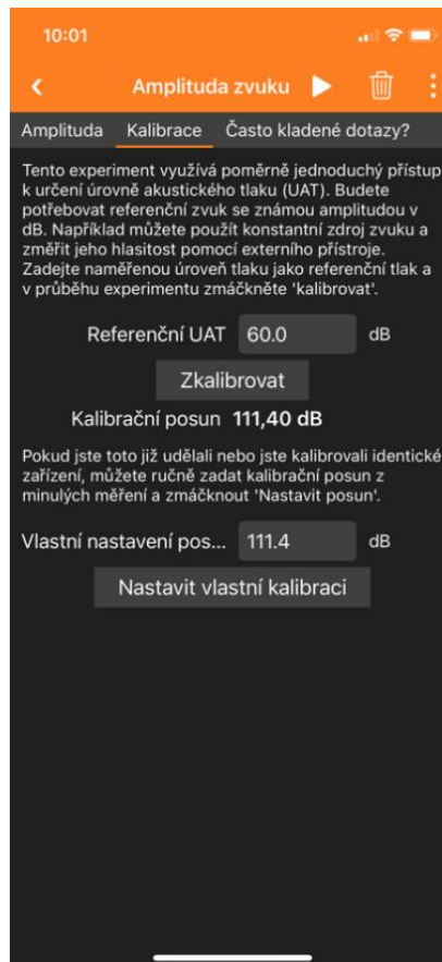
Obrázek 8: Kalibrace aplikace phyphox
