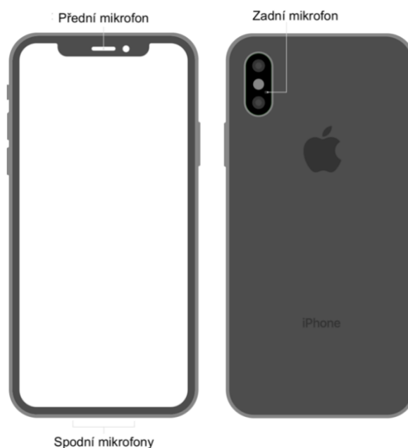
Obrázek 3: Mikrofony iPhone X, upraveno [51]
