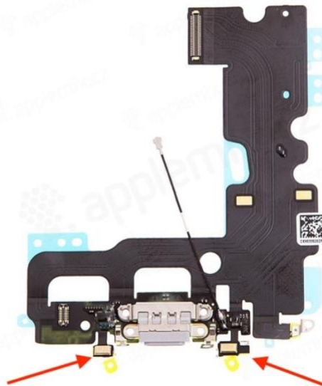
Obrázek 4: Náhradní napájecí modul pro iPhone 7 [52]
