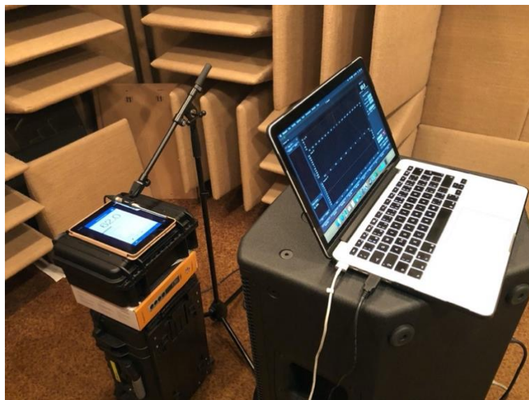
Obrázek 6: Měření v bezodrazové komoře
