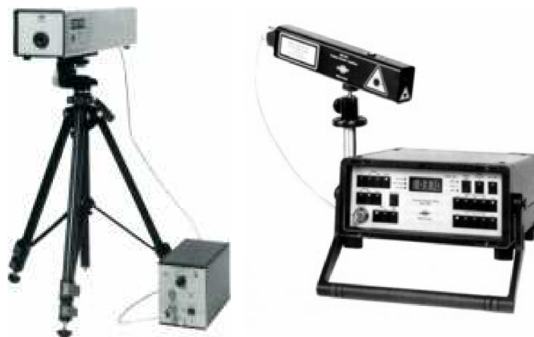
Obr. 25 Bezkontaktní laserové snímače torzních vibrací B&K Type 3544 a B&K Type 2523
