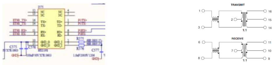
Obr. 28: Příklad zapojení ethernetového portu v testované desce a jeho vnitřní schéma zapojení
