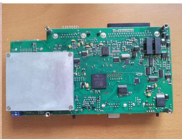
Obr. 6: Foto testované desky plošného spoje s modulem CM-iTC
